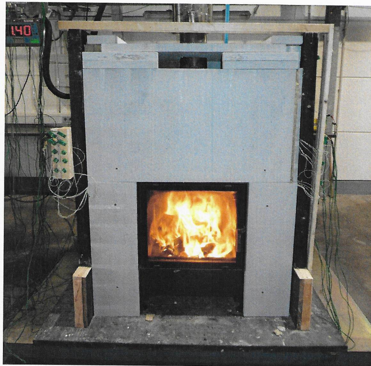
Abb. 5 Prüfaufbau des ersten Versuchs - Anlage wird trockengeheizt (noch mit offenen Konvektionsluftöffnungen)
