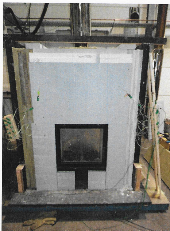
Abb. 6 Prüfaufbau des dritten Versuchs - Anlage front-seitlich offen gelassen, um die Dämmschichten darzustellen. Warmluftaustritt 0 cm 2 und Kaltlufteintritt 160 cm 2
